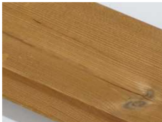
Malé pozdĺžne trhliny na povrchu sú povolené.
